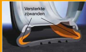
SSR-banden hebben bij drukverlies nog een actieradius tot 80 km bij een maximumsnelheid van 80 km/h.
